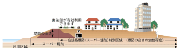
図-2 スーパー堤防断面図
