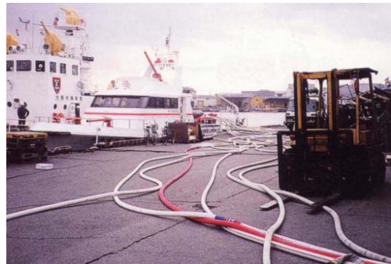
写真6 長田港より1.2km離れた長田区火災現場まで海水を中継送水
